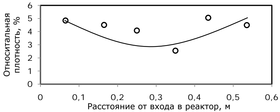
Рисунок 4.26— Распределение относительной плотности слоя порошка меди по длине реактора.
